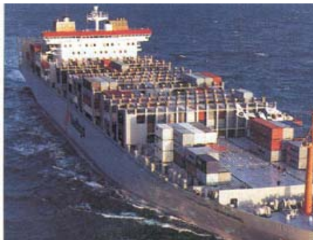
Porte-conteneurs mixte : classique (à l'avant) / plein ciel (centre navire) source : containerisation International
